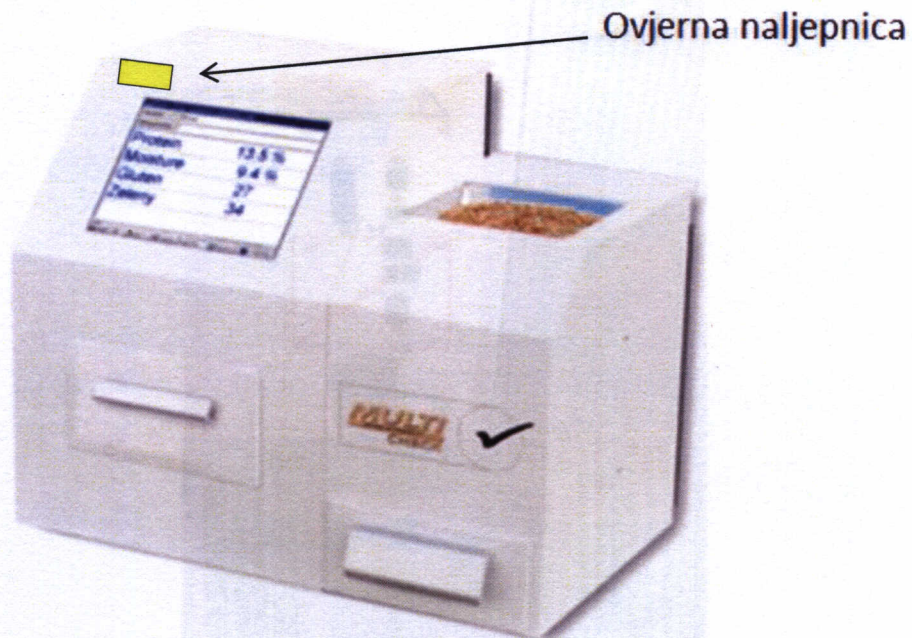
Slika 3. MultiCheck™; mjesto za postavljanje ovjernog žiga u obliku naljepnice
